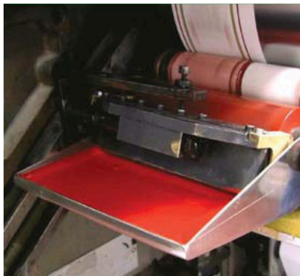
Curățarea cernelurilor de pe cilindrii flexografici
